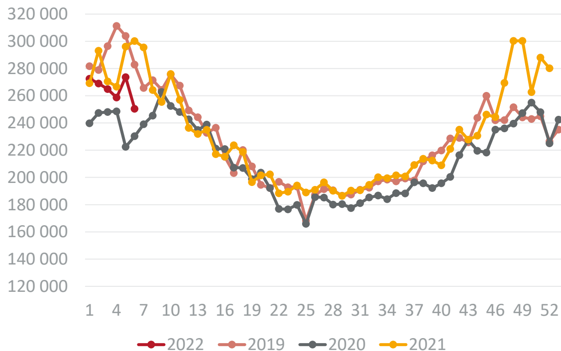
Średnie zapotrzebowanie na elektryczność (w MW) w Finlandii w poszczególnych tygodniach roku
